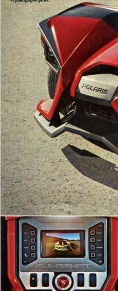
⌚ Качественная аудиосистема с шестью колонками обеспечивает весьма приличный для столь специфического транспорта звук. На 4,3-дюймовый экран «головы» выводится также картина с камеры заднего вида.
