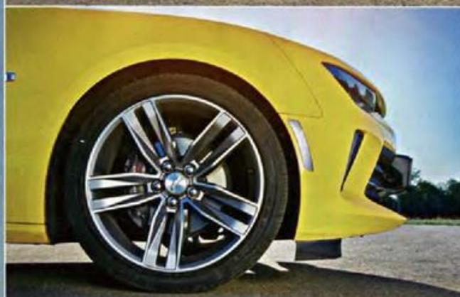
Тормозные диски у «Рогатки» вентилируемые, диаметром 298 мм и спереди, и сзади. Их потенциала лёгкому «зажигалке» хватает всегда, а на скользких покрытиях интеллигентно настроенная ABS качественно ассистирует водителю.
