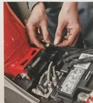
Резистор в «правильном» разьеме делает из базового варианта BMW S 1000 R полноценного «спортсмена»: компьютер активирует режим двигателя Dynamic Pro
